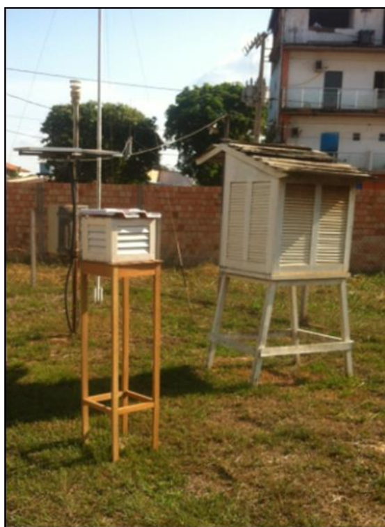
FIGURA 21: COLETA DE DADOS DO ABRIGO EM MADEIRA COM VENEZIANAS E ABRIGO EM MADEIRA DO INMET.
