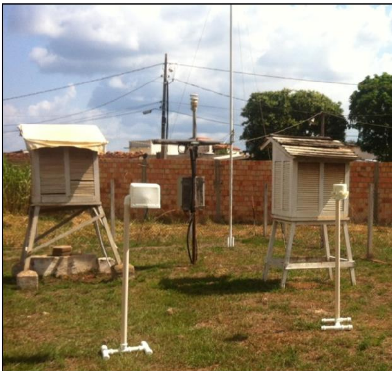
FIGURA 19: COLETA DE DADOS DO ABRIGO EM PVC, PVC COM ISOLANTE TÉRMICO ISOPOR E MADEIRA INMET.
